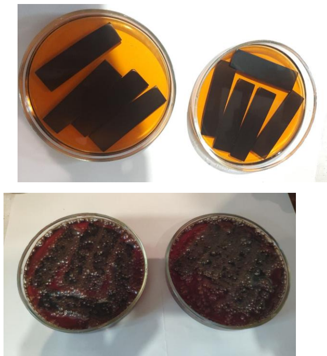
Рисунок 2.6 - Модифікація графітової поверхні шляхом занурення у водний розчин, в якому відбувалось відновлення діазонієвої солі гіпофосфітом натрію
