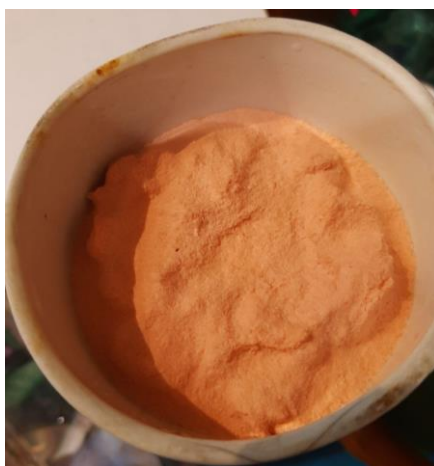
Рисунок 2.5 – Синтезований бензендіазоній тетрафторборат
