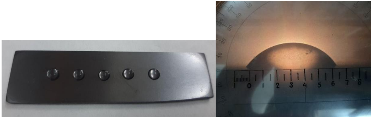
Рисунок 3.1 - Визначення крайового кута змочування на графіті марки МПГ-7
