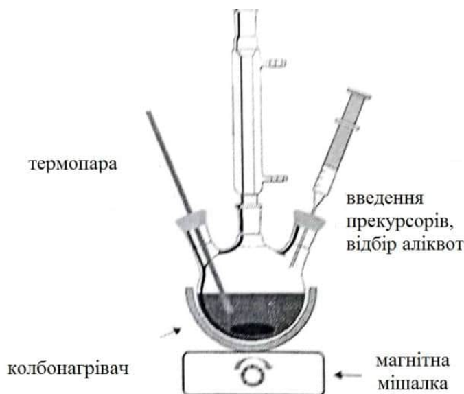
Рис. 2.23. Схема установки для проведення синтезу наночастинок
