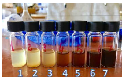
Рис. 6.1. Фотографія проб розчину наночастинок CdSe відібраних через 1 – 15 хв, 2 – 30 хв, 3 – 75 хв, 4 – 135 хв, 5 – 195 хв, 6 – 255 хв, 7 – 315 хв за температури синтезу 200 °С
