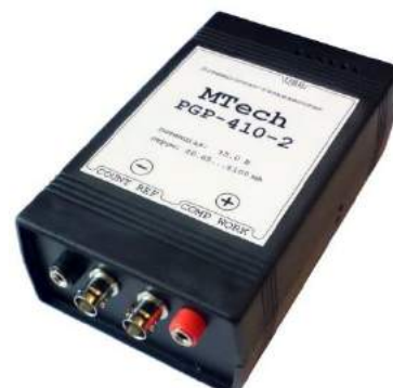
Одна з розробок групи MTech Lab – мультифункціональний прилад для електро-хімічних методів дослідження
