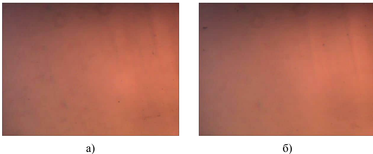
Рисунок 5.2 – Морфологія поверхні GaSb після ХМП в: а) – БР, б) – БР:ЕГ = 80:20.
