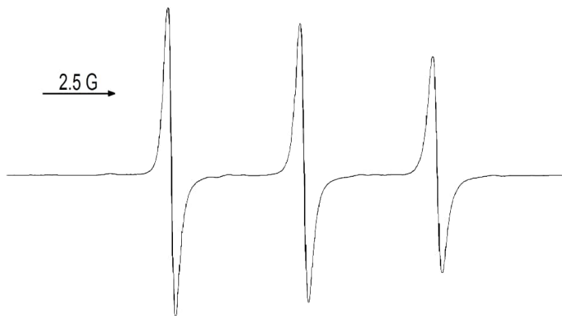
Рис. 3.5 – ЕПР-спектр 4,5-дихлор- N -оксильного радикала ( g = 2,0074 , a_{\text{N}} = 4,42 Гс).
