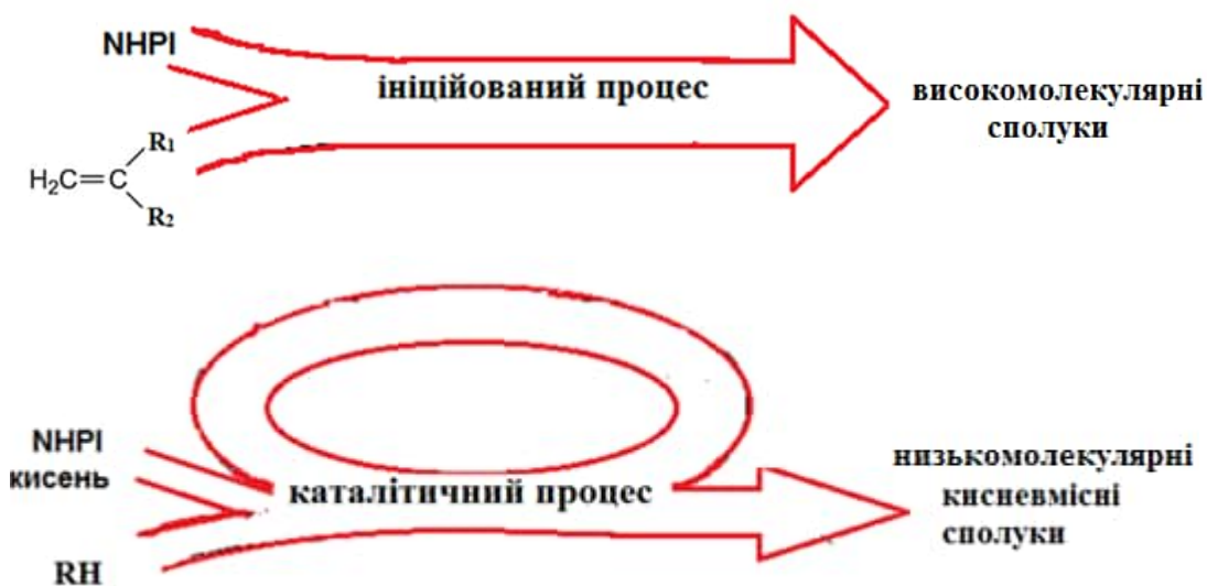
Схема 8.11 – N -гідроксифталімід – промотор ініційованого та каталітичного процесів з утворенням полімерів та малих органічних сполук.
