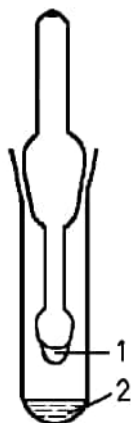
Рис. 3. Прилад для виявлення мікрокількостей аренів: 1 – крапля реагенту; 2 – аналізований розчин.
