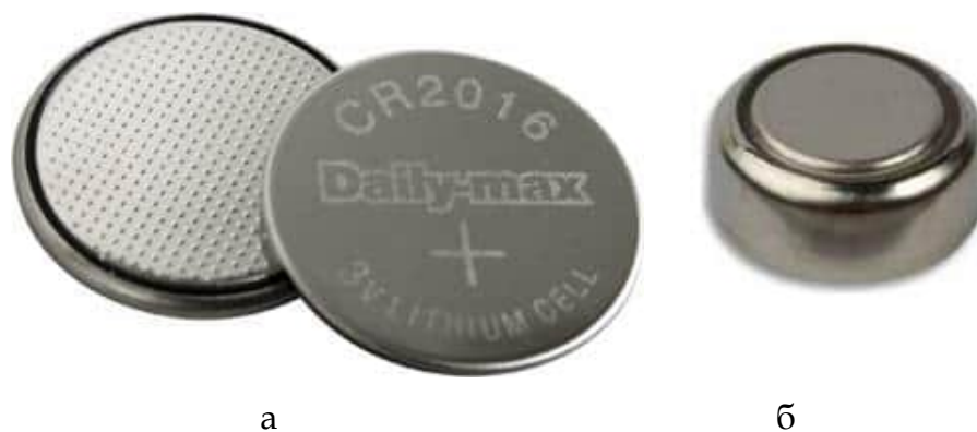
Рис.1.8. Елементи дискового (а) та таблеткового типу (б)
